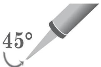
Вставьте файл-пакет в пистолет, обрежьте сверху, а также наконечник под углом ок. 45° в зависимости от ширины шва.
